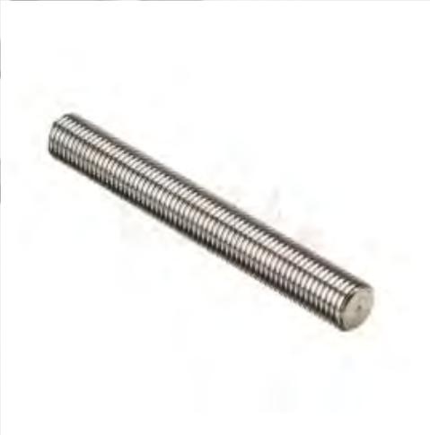
Le paquet contient: 1 x Vis trapézoïdale T16 Ø16 mm pitch 3 mm 1 principe 100 cm Idéal pour déplacer les axes des machines CNC. Il peut être utilisé à la place des barres filetées normales, garantissant une amélioration notable de la précision et une réduction du nombre de jeux. L'objet qui recevra peut différer dans certaines caractéristiques de celui représenté dans l'image, en fonction du lot de production. Malgré cela, la fonctionnalité est maintenue.
